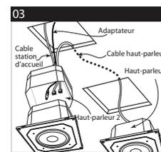
03 Connectez le câble de la station d'accueil, le câble du haut-parleur et le câble de l'adaptateur aux connecteurs de la carte de circuits imprimés située dans le compartiment du haut-parleur le plus volumineux.
