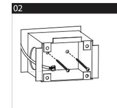
02 Passez le câble à travers le trou du boîtier de fixation, puis fixez le boîtier.
