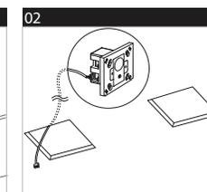
02 Tirez sur le câble branché au préalable à la prise de volume/auxiliaire et passez-le à travers l'un des deux trous.
