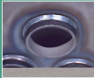
Cet anneau est soudé par l'extérieur du fond (ou du dessus) de la cuve, laissant 3/4 de pouce (1,9 cm) de l'anneau d'acier à l'extérieur de la base du réservoir, permettant ainsi une meilleure soudure avec la cheminée interne.
