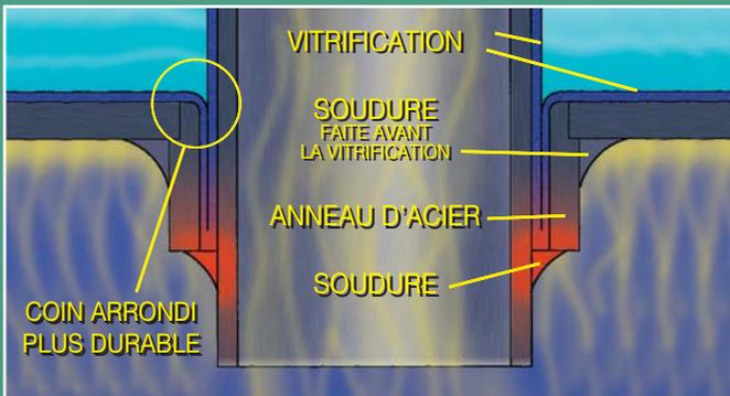
Ensuite, la soudure des cheminées internes aux anneaux d'acier s'effectue loin de la section vitrifiée de la base et des cheminées internes. Ceci permet d'éviter que les sections vitrifiées soient endommagées par la soudure.
